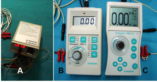
Resim 2.2 Braun firmasına ait nörostimülatörler. En eski model (A), en yeni model (C). Model geliştikçe ekran büyüklüğü ve ekran bilgilerinin arttığı resimde görülmektedir.
